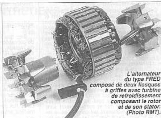
L'alternateur du type FRED composé de deux flasques à griffes avec turbine de refroidissement composant le rotor et de son slator. (Photo RMT).
